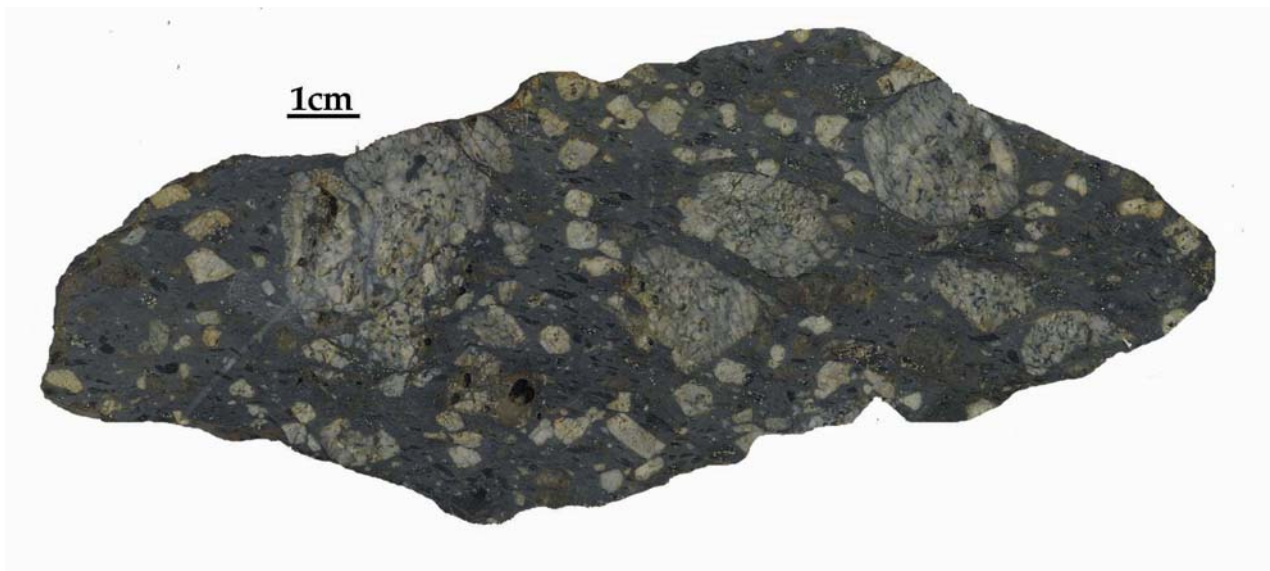
Foto 2.28: Detalle textural de una de las muestras de las ignimbritas. Se observa la orientación de los vidrios volcánicos, definiendo una foliación primaria eutaxítica (Muestra: 28-100).
