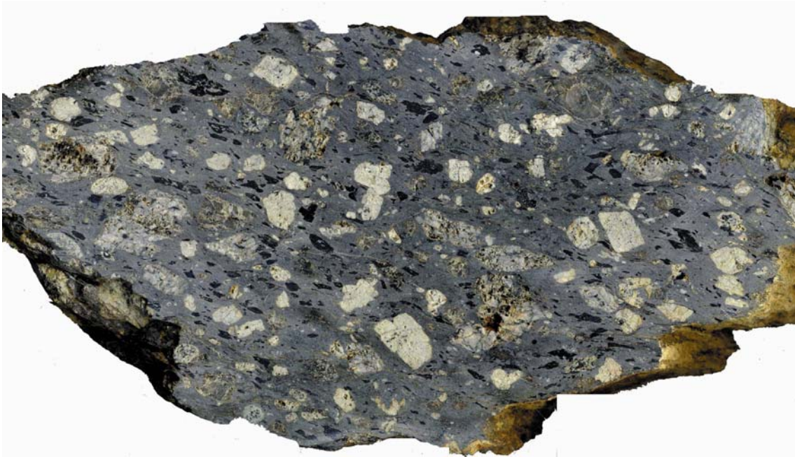
Foto 2.29: Detalle textural de una muestra de las ignimbritas. (Muestra: 268-44). Se observa la presencia de fenocristales y cristales fragmentados, así como fragmentos de vidrios negros aplastados que definen una fábrica eutaxítica.
